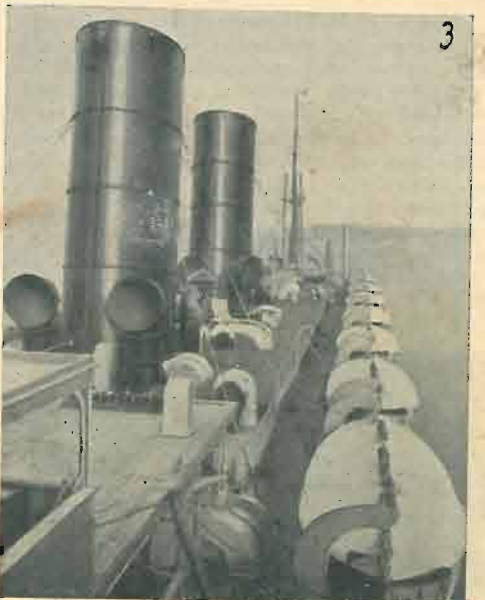
Fig. 3. - Le imbarcazioni di salvataggio, appese alle gru, a sbalzo fuori delle murate.
